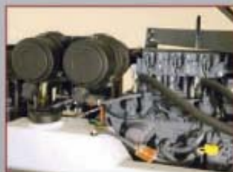
Двойните филтри осигуряват надеждна работа на машината дори при много висока запрашеност
