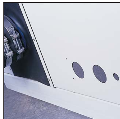
Acceso cableado. Electric cable entrance.
